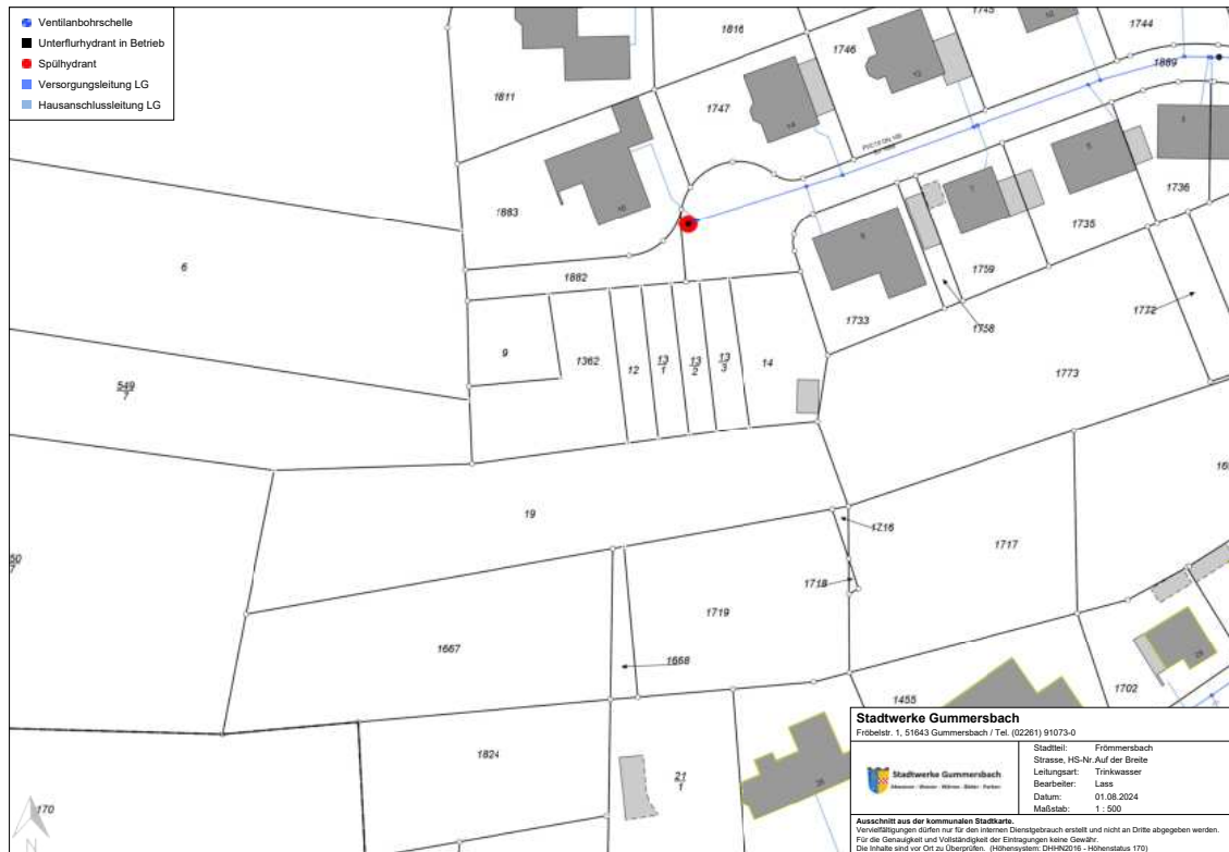
Abbildung 6: Bestandsplan Wasserleitungen (Quelle: Stadtwerke Gummersbach, 2024)
