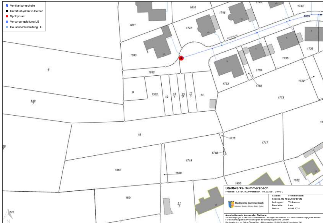
Abbildung 10: Bestandsplan Wasserleitungen (Quelle: Stadtwerke Gummersbach, 2024)
