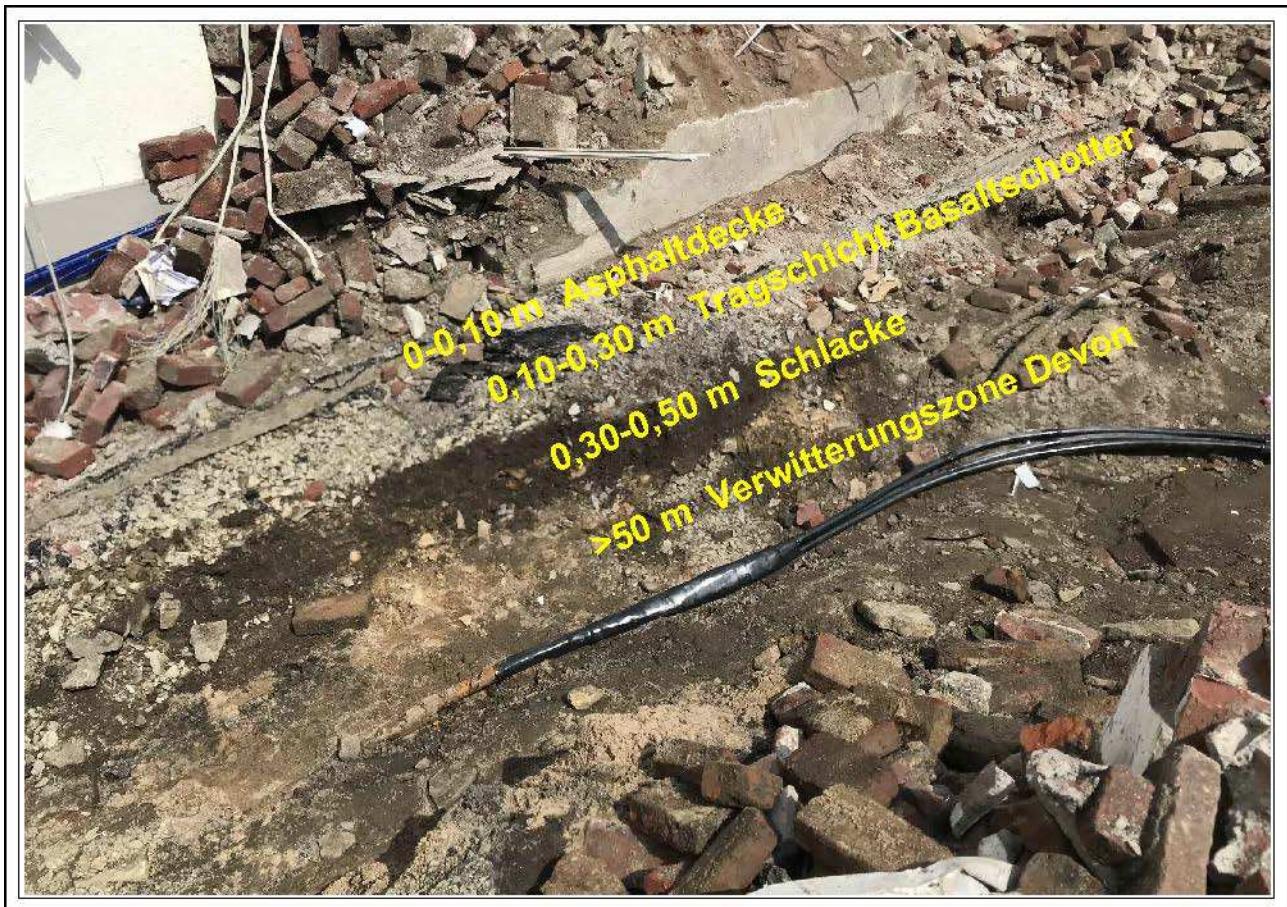
Abbildung 7: Foto vom 27.04.2023: Repräsentativer Bodenaufbau in Schurf 10
