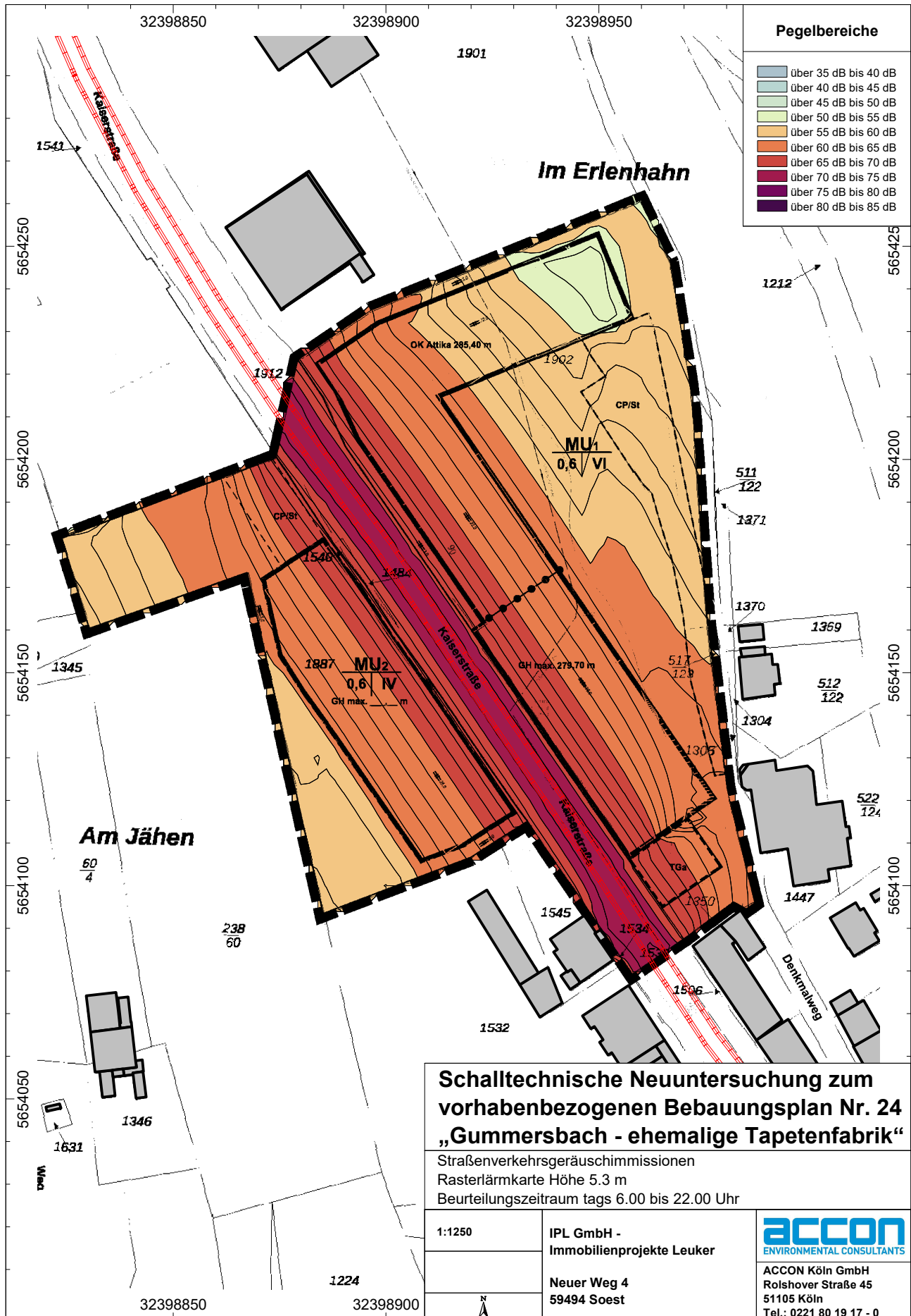
Abb. 4.2.2 Verkehrsgeräuschsituation innerhalb des Plangebiets tags in Form einer Lärmkarte für eine freie Schallausbreitung in einer Höhe von 5,3 m (1.OG)
