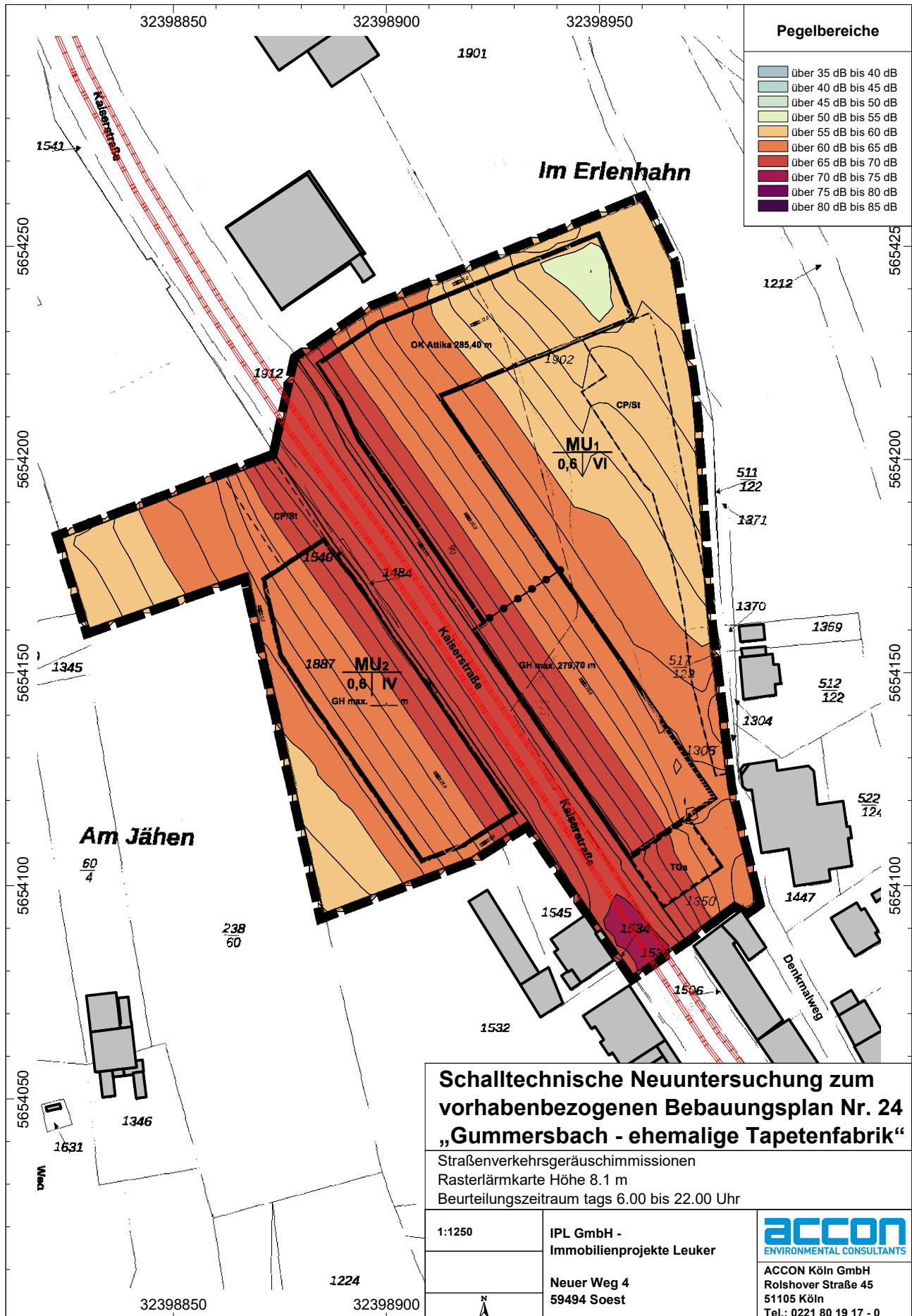
Abb. 4.2.3 Verkehrsgeschwindigkeitssituation innerhalb des Plangebiets tags in Form einer Lärmkarte für eine freie Schallausbreitung in einer Höhe von 8,1 m (2.OG)
